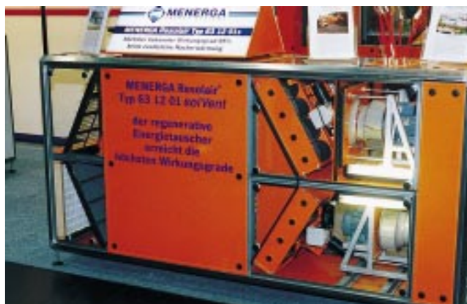
Bild 5 Abenergie-nutzungsgerät mit regenerativem Energieübertrager für Schwimmbadeinsatz
