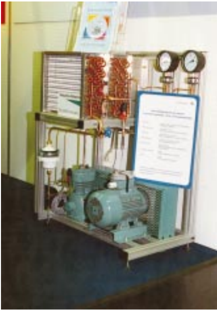
ILK-Ammoniakkältesatz für Luftentfeuchtung
