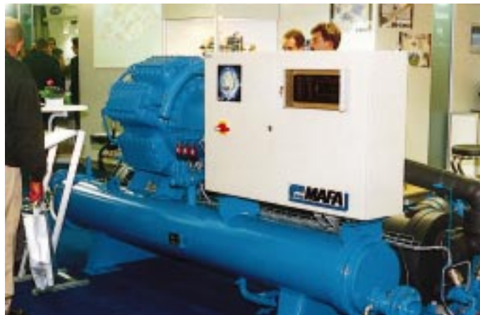
ILKA MAFA-Kompaktkältesatz mit halbhermetischem Ammoniakverdichter
