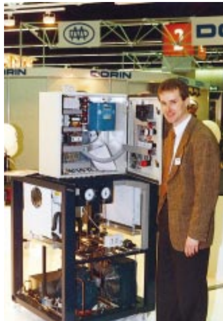
Prokurist M. Trauer von Erba-Kälte zeigt stolz die Anwendung des neuen Frequenzumrichters in einer Kältesatzsteuerung
