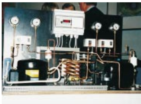
Die preisgekrönte 2stufige Anlage mit Zwischeneinspritzung und Unterkühlung des Kältemittels
