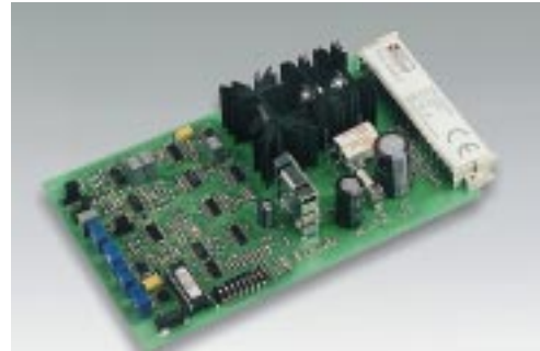
Der neue Drive Control DC 10-S zum Regeln oder Stellen von DC-Motoren
