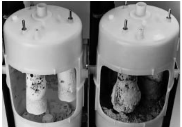
Eine wesentlich längere Lebensdauer der Dampfzylinder (linkes Bild) ermöglicht das SC-Selbstreinigungssystem von Nordmann gegenüber einer Normalausführung (rechts Bild)
