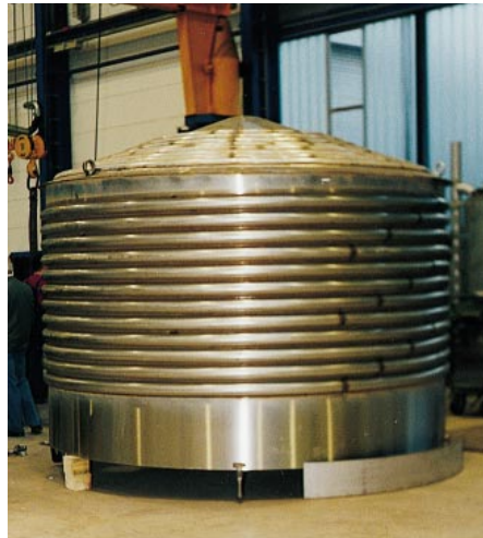
Ein Zylindro-konischer Tank – oben ist unten –, mit den aufgeschweißten Kühlrohren
