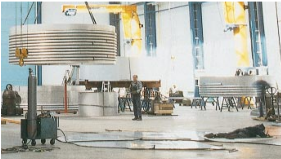
Die zylindro-konischen Tanks gehören zu den größten Apparaten, die zu sehen waren, und verlangen der Fertigung große Erfahrung und diszipliniertes Arbeiten ab
