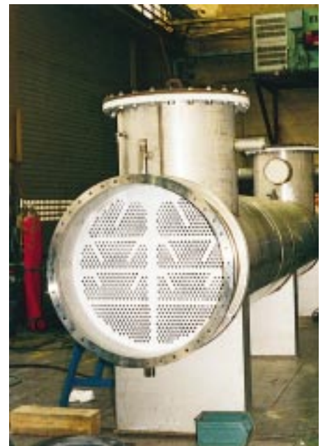
Diese Wärmeübertrager aus Edelstahl konnten auf ihrem gesamten Fertigungsweg verfolgt werden. Anstrengend und verantwortungsvoll hinsichtlich des Dichtheitsergebnisses ist das Einschweißen der einzelnen Rohre
