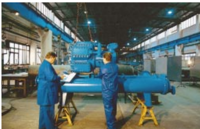
Abnahme eines Ammoniak-Kaltwassersatzes mit Halbhermetikverdichter für 400 kW Kälteleistung
