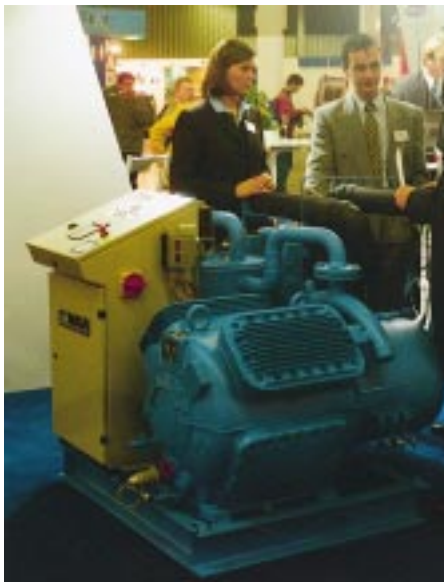
Am Beispiel des Kältewürfels ist die mögliche Kompaktheit mit Halbhermetikverdichtern gut zu demonstrieren, hier auf der IKK 1998
