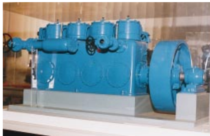
Ammoniakverdichter früherer Generation aus der Modellsammlung des Werkes
