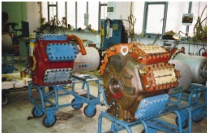
Montageplatz für die Ammoniakverdichter bei ILKA Mafa Halle
