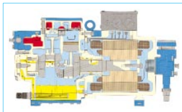
Bild 4 Schnittbild HG5-Verdichter. Das Sauggas wird durch das Motorgehäuse geführt
