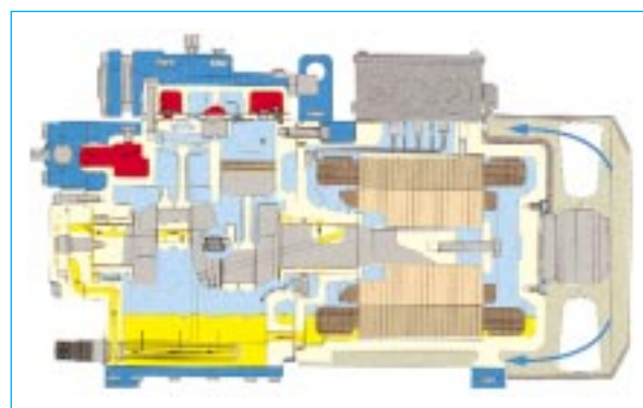
Bild 3 Schnittbild HA5-Verdichter. Das Sauggas gelangt über das Saugabsperrentil direkt in den Verdichter. Die Motorkühlung erfolgt über den Lüfter
