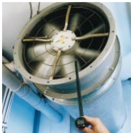
testo 405-V1, ein Mini-Anemometer zur Erfassung von Luftströmung und Volumenstrom
