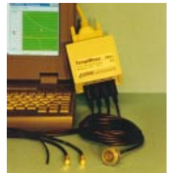
Mit TempMess können Temperaturen zwischen -45 °C und 130 °C gemessen und visualisiert werden
