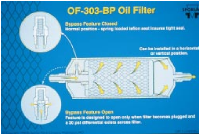
Bild 7 Bypassventil des Ölfilters geschlossen. Das Bypassventil öffnet nur, wenn der Ölfilter verschmutzt ist und dadurch der Differenzdruck bis zu 2,1 bar ansteigt
