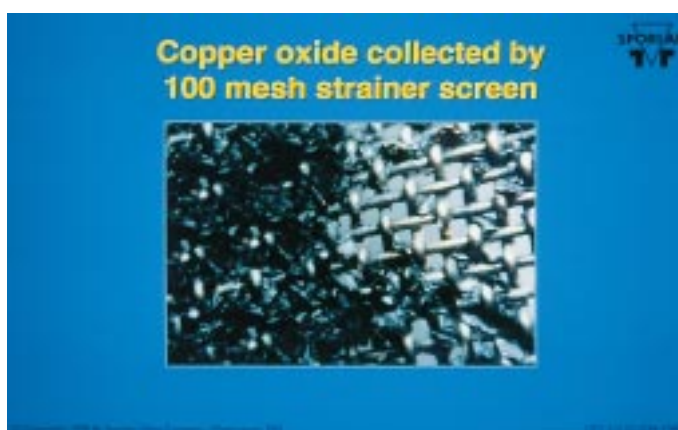
Bild 2 Kupferoxid-Teilchen entstehen bei der Lötarbeit im Rohrnetz. Nur die größeren Partikel werden im Sieb mit 100 mesh aufgefangen, während kleinere Teilchen das Sieb passieren
