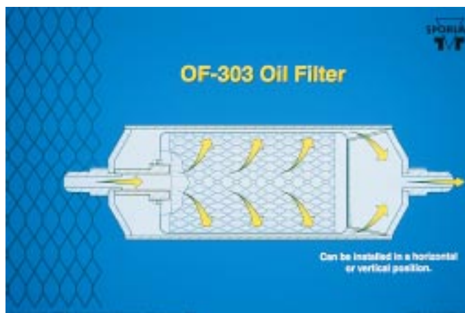
Bild 6 Einbau des Ölfilters, wahlweise horizontal oder vertikal
