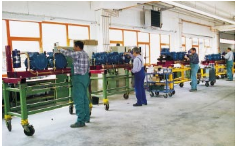
Übersichtliches Arbeiten in der neuen Fertigungshalle. Die Verdichter sind aufgesetzt, die vormontierten Baugruppen werden angebaut
