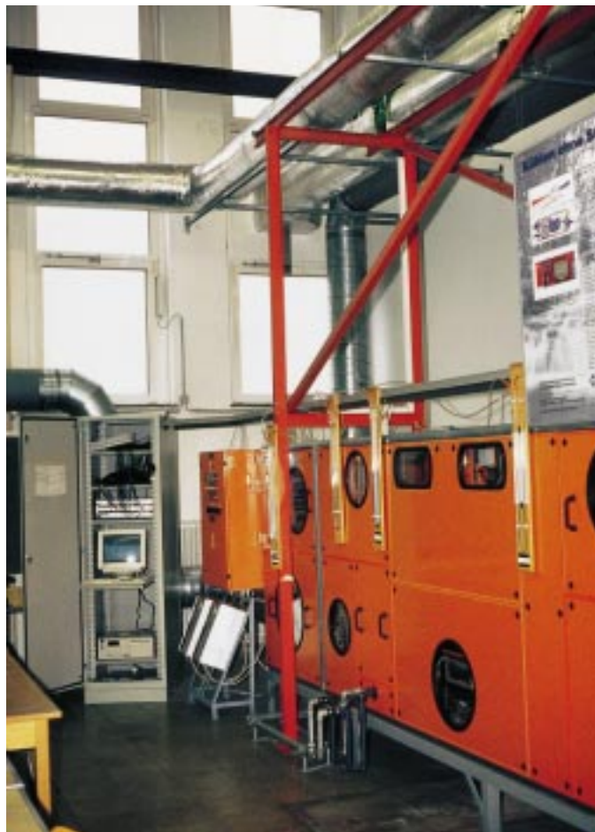
Bild 2 Klima-Kälteprüfstand der Fachhochschule Dortmund
