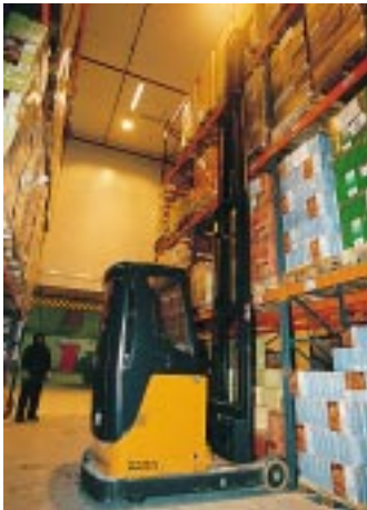
Der Schubmaststapler FM ist für Einsätze in Kühlhäusern bis -30^{\circ}\text{C} geeignet
