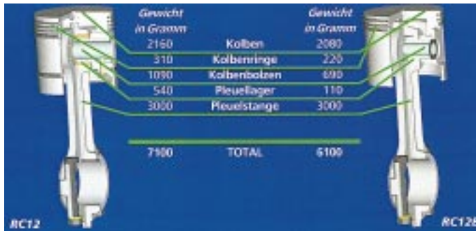
Bild 2 Gewichtsreduzierungen bei Kolben und Pleuel
