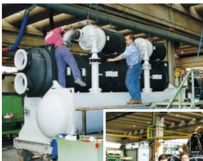
Doppelturbo-Montage für Deutschland. Rütgers-Geschäftsführer Josef Neuberger (unten rechts) zusammen mit dem McQuay-Werksleiter in Cecchina vor einer anderen für seine Firma bestimmten fertigen Versandeinheit, ein R 410A-Flüssigkeitskühler mit Doppelschraube
