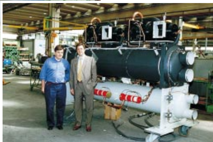
Doppelturbo-Montage für Deutschland. Rütgers-Geschäftsführer Josef Neuberger (unten rechts) zusammen mit dem McQuay-Werksleiter in Cecchina vor einer anderen für seine Firma bestimmten fertigen Versandeinheit, ein R 410A-Flüssigkeitskühler mit Doppelschraube
