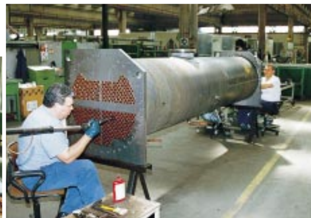
Fast alles Eigenbau in Cecchina. Eindrücke von der Behälter- und lamellierten Verflüssiger-batterie-Fertigung
