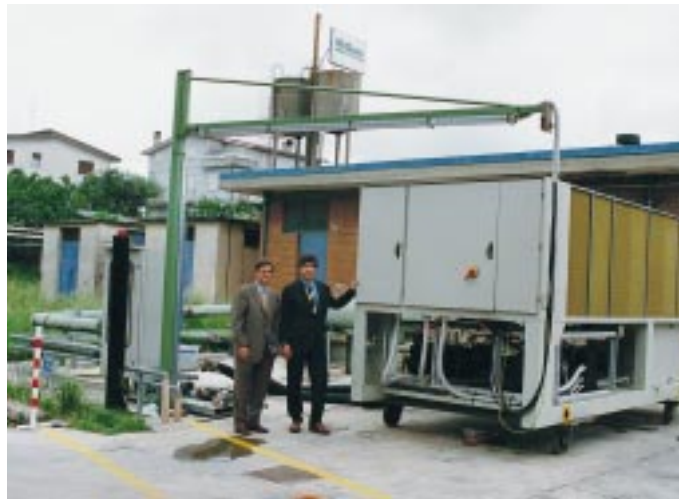
Abnahmeprüfung unter Vollast bei aufstellungsspezifischen Umgebungstemperaturen
