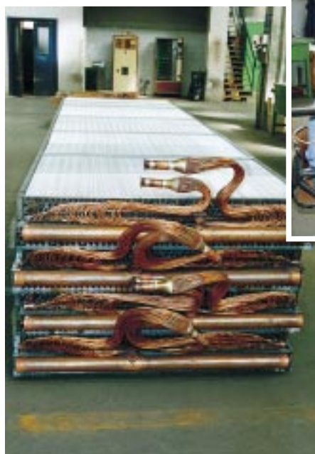
Fast alles Eigenbau in Cecchina. Eindrücke von der Behälter- und lamellierten Verflüssiger-batterie-Fertigung
