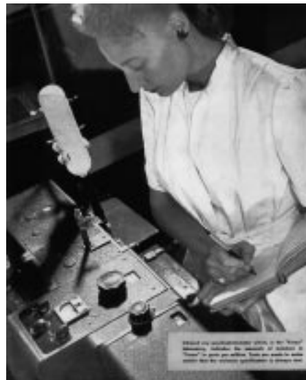
Infrarotstrahlen-Spectrophometer-Test im „Freon“-Laboratorium um 1930. Bestimmung des Feuchtigkeitsgehaltes in ppm aus der laufenden F 12-Produktion
