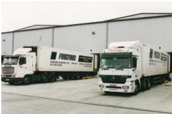
Frisches Obst verlangt eine gesunde Kühlkette. Andoggen der Kühltrailer an die gekühlte Auslieferungzone
