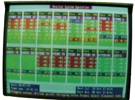
Unten links werden Funktionsabläufe der Kälteanlage sichtbar, das Bild unten rechts zeigt die Lufttemperaturabläufe im/am Verdampfer für den NH 3 -Pumpenbetrieb
