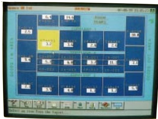
Temperatur- und Prozeßvisualisierung. Abfotografiert vom IBM-Bildschirm: Oben links ist der Temperatur-Grundriß aller Lager Räume zu erkennen, oben rechts die verschiedenen Meßfühlerpositionen.
