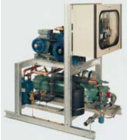
Wassergekühlter Verflüssigungssatz von Bock für eine Anwendung in der chemischen Industrie mit offenem Verdichter und diversem Sonderzubehör
