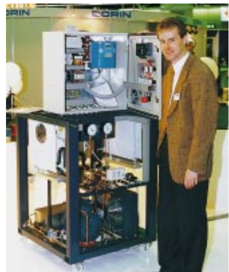
Bild 3 Dipl.-Ing. M. Trauer zeigt die Einbindung des KIMO-Frequenzumrichters (blaues Gehäuse im Schaltschrank) in die Anlagensteuerung
