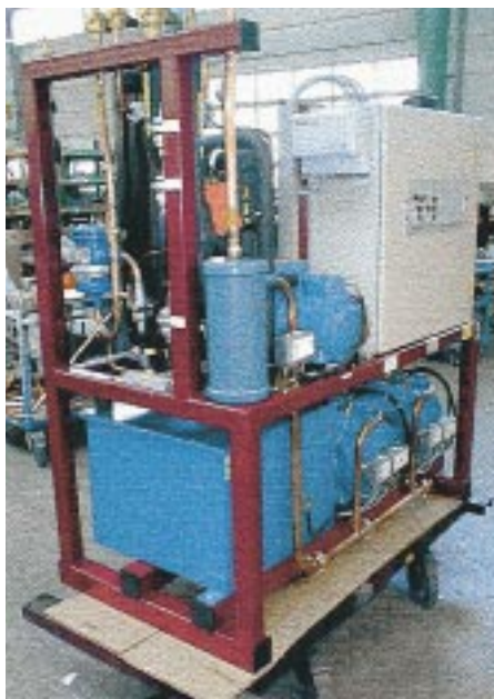
Bild 4 Maschinengestell mit dem Kaskadentauscher Thermosafe
