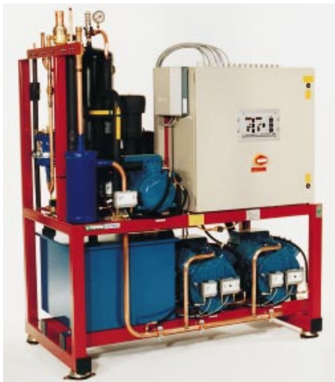
Bild 5 Verwendeter Verdichter – Frascold 4-Zylinder/Bauserie S
