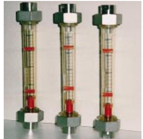
Bild 5 und 6 Volumenmeßgeräte mit Schwebekörper
