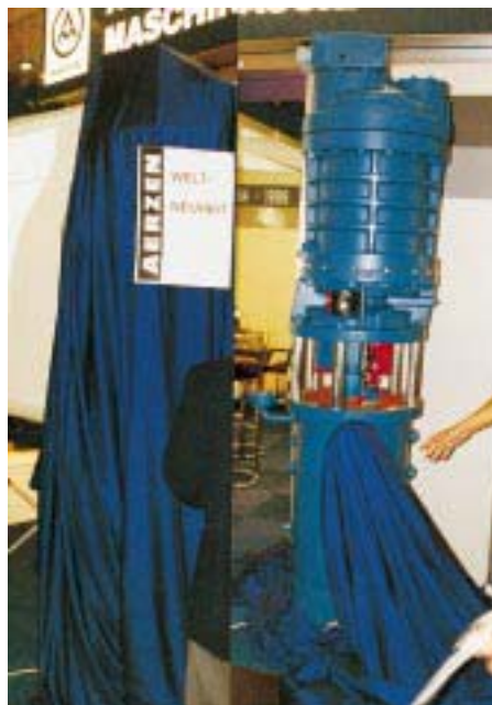
Halbhermetischer Schraubenverdichter mit senkrechter Wellenanordnung der Aerzener Maschinenfabrik vor und nach der Enthüllung
