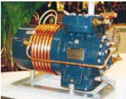
Der CO 2 -Verdichter von Dorin mit äußerlich wassergekühltem Motor
