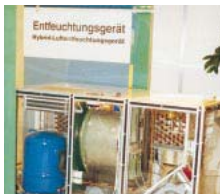
Hybrid-Luftentfeuchtungsgerät aus dem ILK Dresden für eine Entfeuchtungsleistung von 0,6–2,8 kg/h
