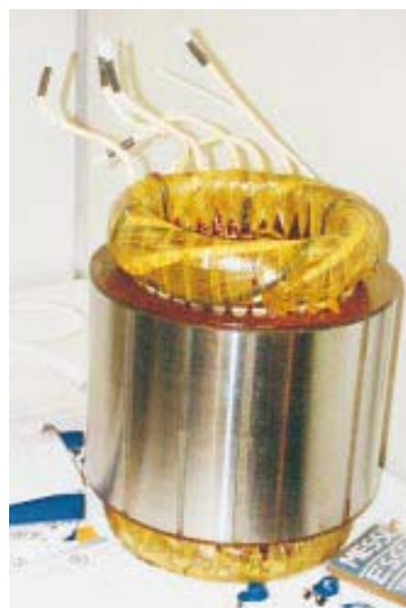
Der ammoniaktaugliche Halbhermetikmotor mit dem großen Drehzahlstellbereich konnte rundum in Augenschein genommen werden
