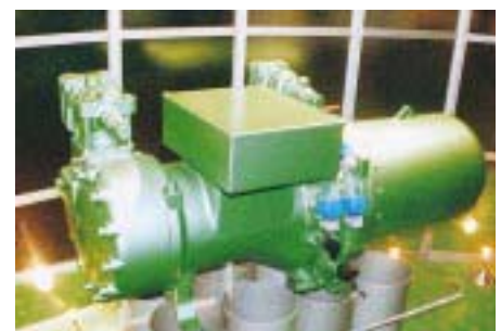
Bitzer-Kompaktschraubenverdichter mit dualer Leistungsregelung. Im mittleren Bereich sind die Magnetventile zur Steuerung der Leistungsregelung zu erkennen
