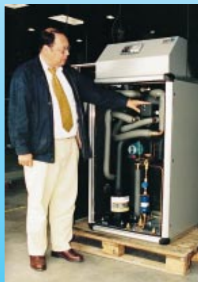
Nahwärmeversorgung mit Wärmepumpen
