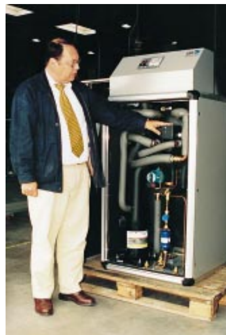
Hiermit hat Reiner Bertuleit schon jahrzehntelange Erfahrung: Eine selbstentwickelte Wärmepumpe, sowohl zum Heizen, als auch zur Brauchwasserbereitung
