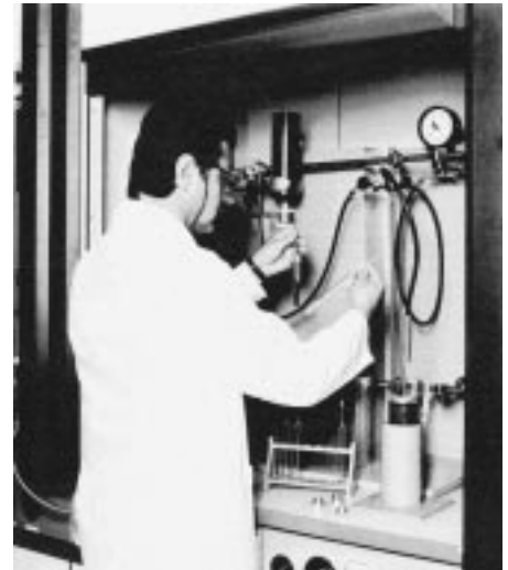
Materialverträglichkeitstest mit SUVA® 134a im „European Technical Centre“ von DuPont, Genf 1992
