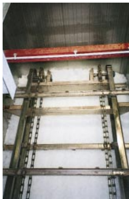
Ein Rechensystem in jedem Bunker sorgt für die Entnahme des Eises von oben her
