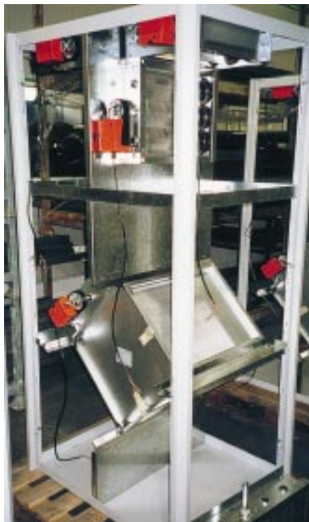
Montage des Mittelteils eines Climabloc-Gerätes mit Mischlufteinheit und Wärmerückgewinnung
