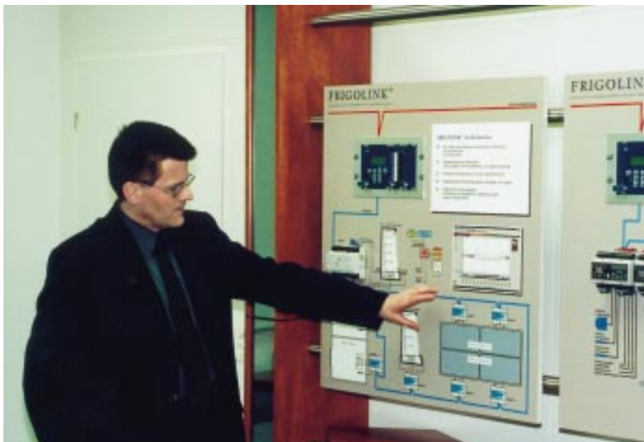
Das „jüngste Kind“ für die Regelung und Überwachung von Kältesystemen aus dem Hause Wurm heißt Frigolink und ist ein System, das auf der CAN-Bus-Technologie basiert
