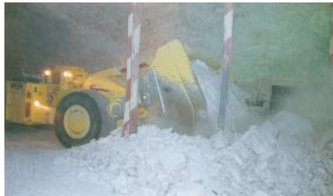
Ein wenig staubig geht's in 1100 m Tiefe schon zu. Einer der dieselmotorbetriebenen Fahrlader in Aktion. Fassungsvermögen bis zu 17 t Salzgestein
