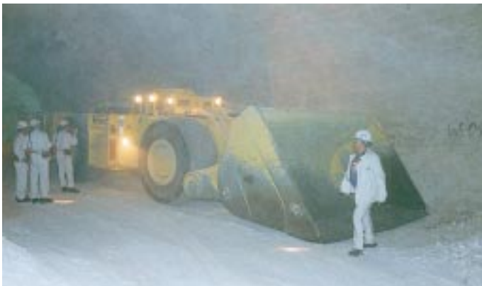
Ein wenig staubig geht's in 1100 m Tiefe schon zu. Einer der dieselmotorbetriebenen Fahrlader in Aktion. Fassungsvermögen bis zu 17 t Salzgestein
