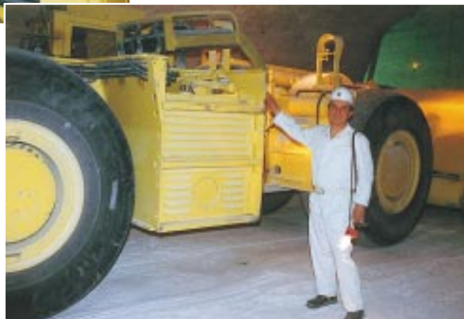
Sonderklimaanlage ACS 700-K für Lufttemperierung, Filterung und Entfeuchtung der Fahrerkabine. Der luftgekühlte Verflüssiger ist „aufgesattelt“, der über eine Magnetkupplung angetriebene Hubkolbenverdichter im Motorenbereich positioniert
