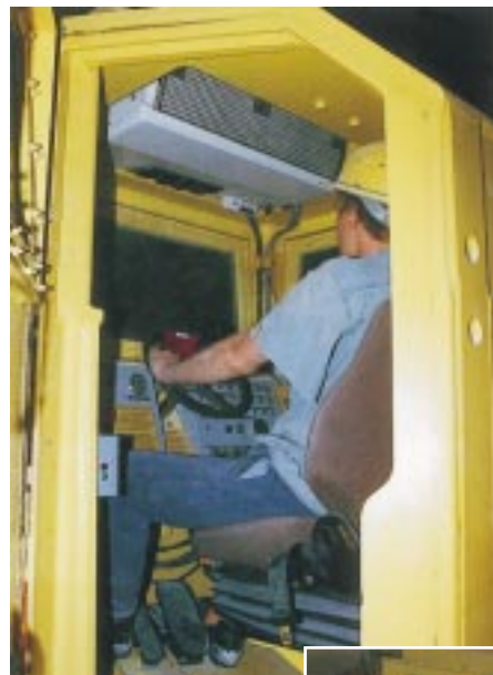
Sonderklimaanlage ACS 700-K für Lufttemperierung, Filterung und Entfeuchtung der Fahrerkabine. Der luftgekühlte Verflüssiger ist „aufgesattelt“, der über eine Magnetkupplung angetriebene Hubkolbenverdichter im Motorenbereich positioniert
