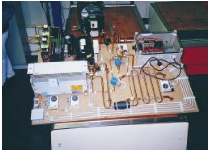
Das hier abgebildete Gesellenstück einschließlich einer Arbeitsprobe (Rohrslangenverdampfer und Halterungen) mußte innerhalb von 14 Stunden funktionstüchtig erstellt werden
