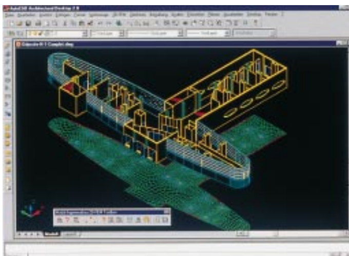
Bild 9 „Ingenieurbau“ ist eine Branchenlösung auf Basis von AutoCAD Architectural Desktop. Sie eignet sich z. B. zur Berechnung von Decken und Bodenplatten (Foto: Mensch und Maschine)
