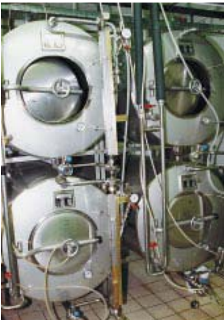
Kälteanlagenbauermeister Peter Klausner (HEIFO Hannover) erläutert KK die gesonderte Binäreis-Vor- und Rücklauftechnik für den Bierherstellungsprozeß. Die Haupttemperaturanzeige am gesonderten Schaltschrank zeigt es, die Binäreisvorlauftemperatur beträgt 0,3 °C, 0 °C wäre die maximal zulässige untere Grenze
