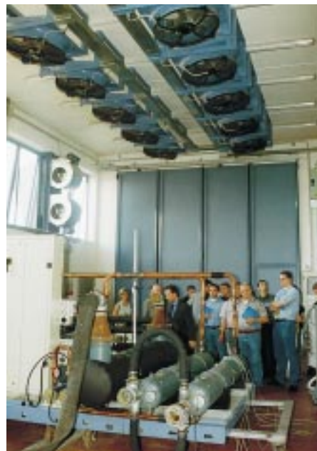
Leistungs- und Funktionsprüfung eines wassergekühlten Flüssigkeitskühlers in der Versuchsabteilung. Hier können unterschiedliche Aufstellungsbedingungen simuliert werden
