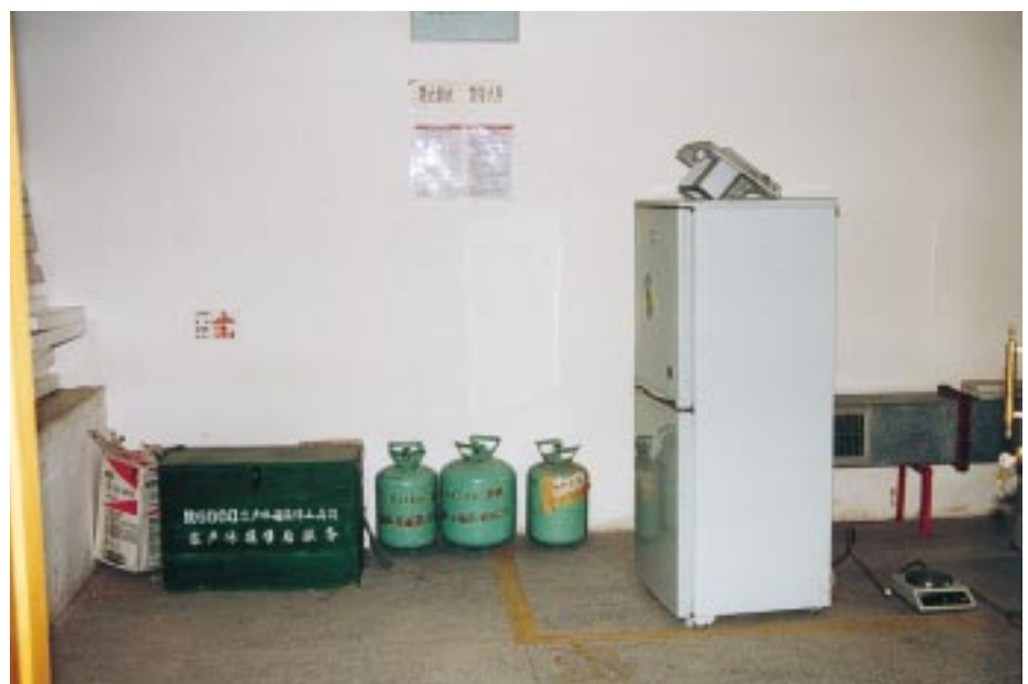
Spezieller Prüfraum eines Kelon-Händlers für R 600a-Kühlgeräte. Im Hintergrund rechts sichtbar ein Abluftkanal
