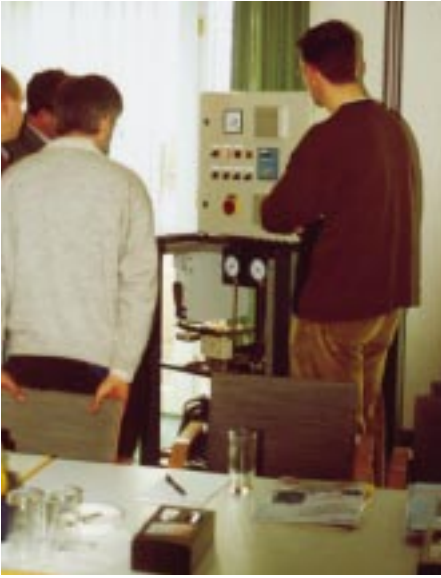
Am Versuchskältesatz konnten alle Funktionen des Frequenzumformers probiert werden
