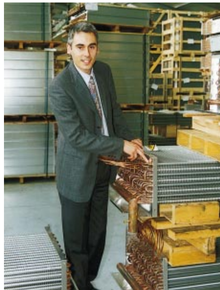
Mit einem Ausdehnungsspiel gibt es für die Kernrohre am Wärmetauscher-Eingang eine besondere Rohrdurchführungstechnik. Hier erklärt von ECO's Chefindgenieur Umberto Di Barbora
