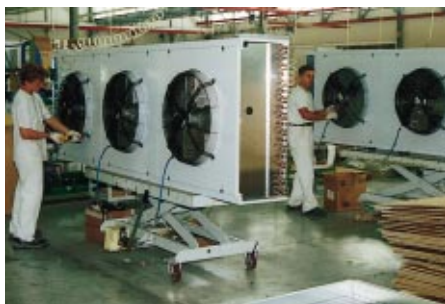
ECO's Verflüssigerbaureihe TCE, bei der jetzt innenkreuzberippte Kupferrohre eingesetzt werden, die den Wärmeübergang um den Faktor 2 bis 2,3 gegenüber Glattrohr verbessern
