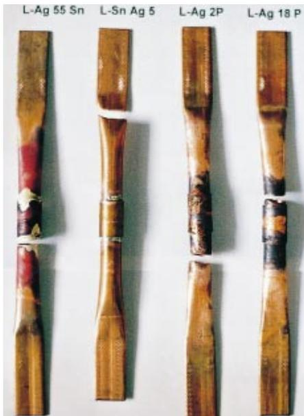
Bild 2 Lötproben nach dem Zugversuch bei Raumtemperatur: Die Hartlötungen brechen neben dem Fitting (Lötstelle), die Weichlötung an der Einspannstelle
