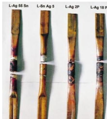
Bild 3 Die Lötproben nach dem Zugversuch bei ca. 150 °C: Bei der Weichlötung wird das Rohr aus dem Fitting gezogen
