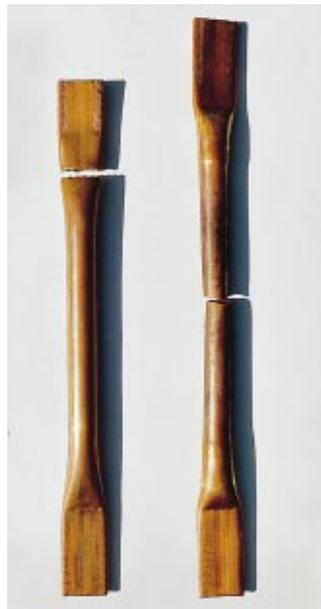
Bild 5 Das unbehandelte Rohr bricht an der Einspannstelle (15 000 N), das geglüht an der Glühstelle (10 000 N). Deutlich erkennt man die mit der verminderten Festigkeit einhergehende Zunahme der Bruchdehnung
