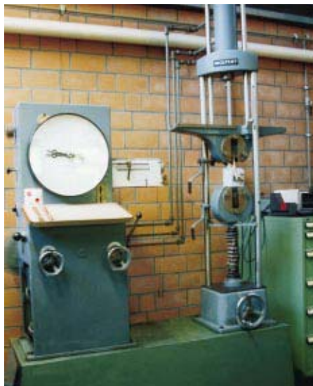
Zugfestigkeitsprüfung unterschiedlicher Lötungen an Kupferrohr. Teil des Berufsschulunterrichts von Oberstudienrat Dieter Schmidt
