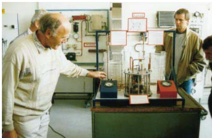
Kältetechnik pur. An der BBS Springe. Studiendirektor Klaus Busold erläutert hier die gläserne Kälteanlage, einmalig auf der Welt
