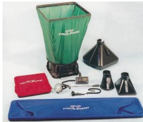
und genaue Lösung dieser sonst problematischen Meßaufgabe. Das Meßgerät der ProHood zeigt sowohl den Volumenstrom ( $m^3/h$ ) als auch die Luft-
