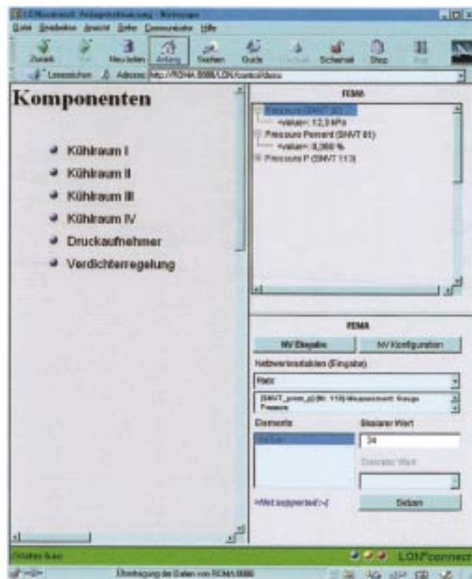
Bild 2: Visualisierung der Anlage in Bild 1 in textueller Form, dargestellt mit Hilfe eines Internet Browsers
