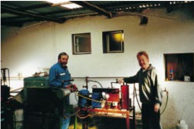
Praktischer Prüfungsteil: Inbetriebnahme und Füllen eines Kaltwassersatzes (linkes Bild), umweltgerechte Entleerung und anschließende Neubefüllung einer Kälteanlage für die Kühlzelle (rechtes Bild)
