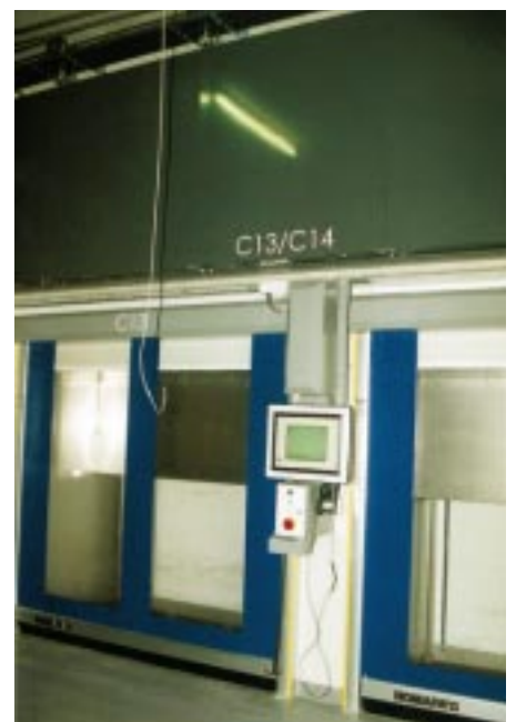
Shuttle-Tor und SPS-Steuerung mittels touch-screen am Shuttle-Tor
