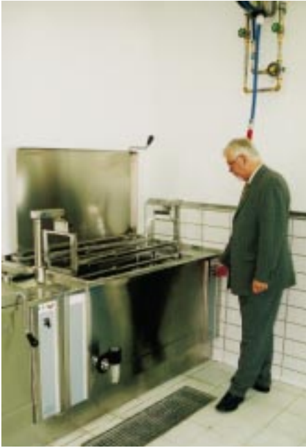
Das ist der „Knaller“. Soßen werden in diesem „Kochkessel“ von ELRO nicht zubereitet, sondern in Plastikbeutel über eine Hebe- und Senkvorrichtung zur Schnellabkühlung in -10\text{ }^{\circ}\text{C} Glykol getaucht. Hierzu stellt P & P Tiefkühlsole von -30\text{ }^{\circ}\text{C} über Platten-WT zur Verfügung
