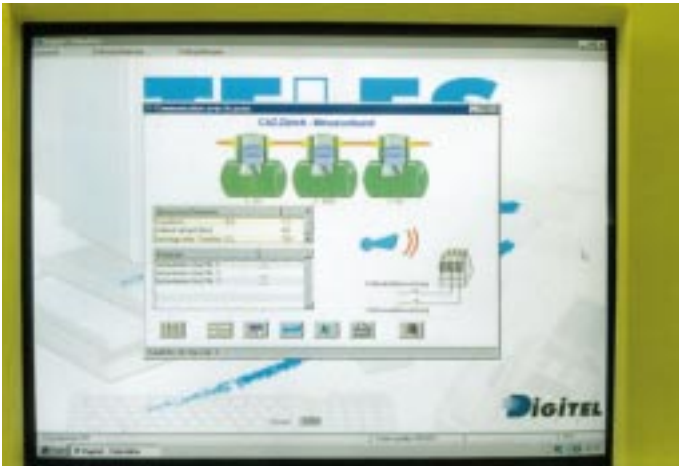
Prozessdatenerfassung und Datenfernübertragung ist obligatorisch. Hier die Visualisierung einer Minusverbundanlage
