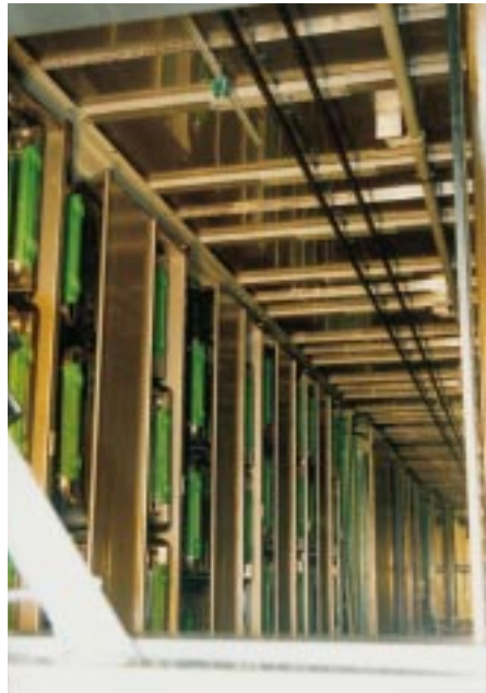
Ein Blick über die Inspektionsöffnung in den 20 m hohen/tiefen Shuttle in dem die Trolleys bis zur Weiterbehandlung bei +2 °C/+4 °C automatisch befördert und geparkt werden
