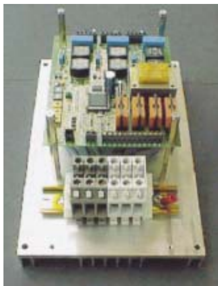
Das neue VSB-Klima-Start Sanftanlaufgerät für 22kW/51A
