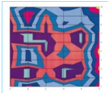
Schwingungsverhalten einer Grundplatte im kältetechnischen Betrieb
