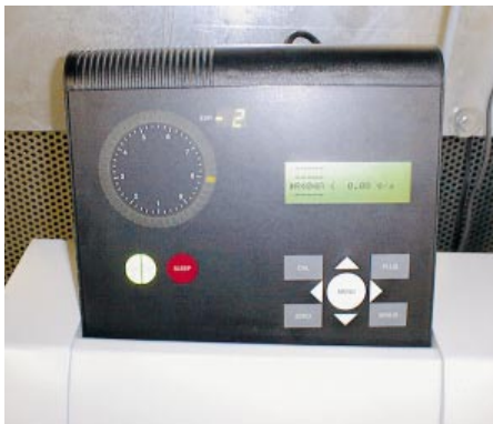
Ein selektiver Gasdetektor ermittelt Leckagequellen von max. 1 gr/Jahr und Fügestelle
