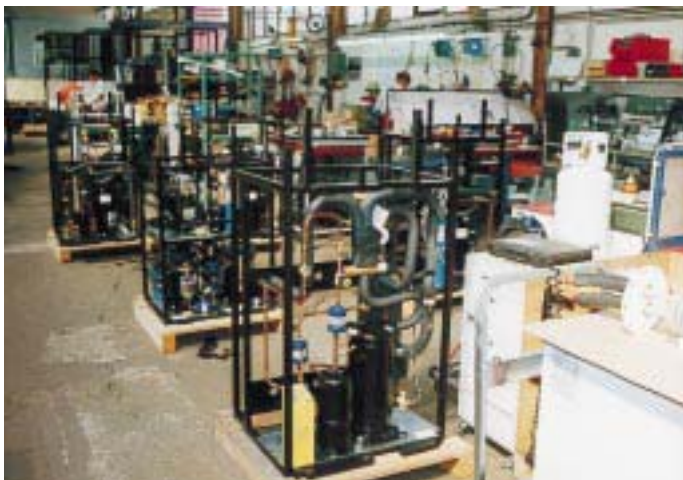
Gesamteindrücke aus der Fertigung. Neben Direktexpansions-Heizwärmepumpen, hier mit der Direktkondensations-technologie, werden seit 1974 auch Brauchwasserwärmepumpen gefertigt
