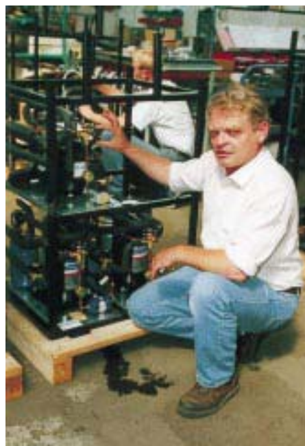
Kälteanlagenbauermeister Herbert Piergalski (Manching) erläutert hier die besondere Technologie der Direktexpansions/Direktkondensationswärmepumpe: 3 Verdichtermodule, 3 voneinander getrennte Verdampfungs- und Kondensationskreisläufe. Eingespritzt wird das Kältemittel R 407C mechanisch-thermisch
