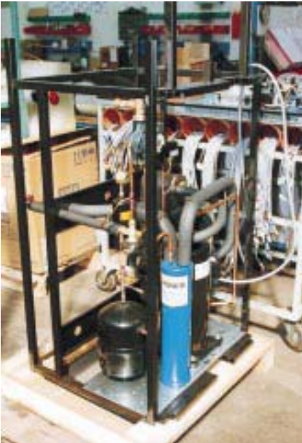
Der Gasphasenmanager von Ochsner erhöht die Betriebssicherheit und die Leistungsziffer der Wärmepumpenanlage
