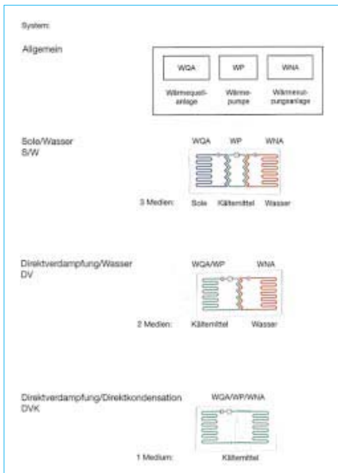
Systemvergleich von Erdwärme-Wärmepumpen-Heizungsanlagen (Werkbild Ochsner)
