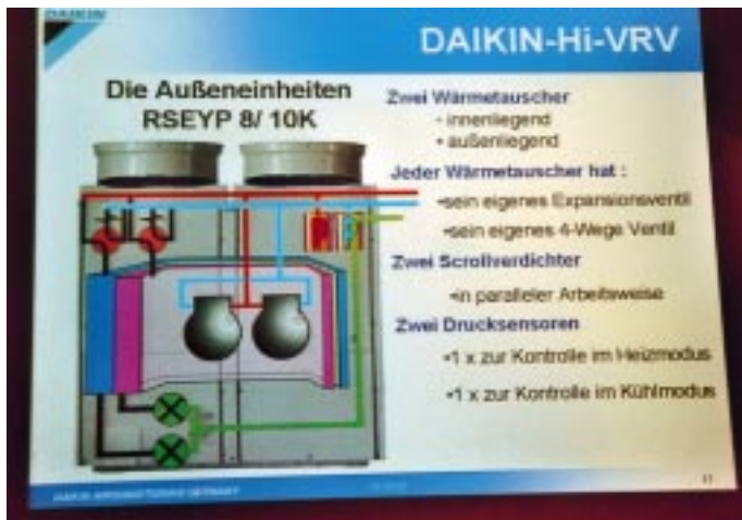
Eine Hi-VRV-Außeneinheit mit zwei integrierten Wärmetauschern sowie die Komponenten für eine Systemlösung
