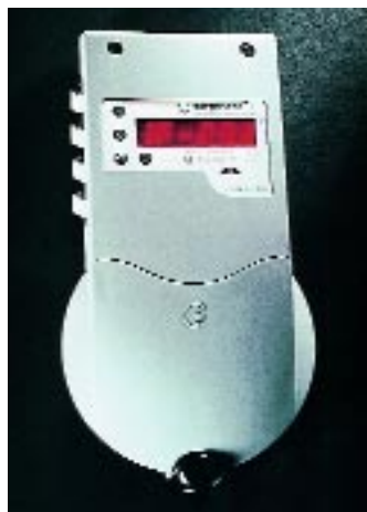
Temperaturschreiber mit integrier- tem GSM-Funkmodul
