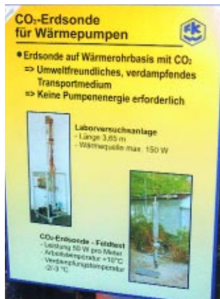
CO 2 -Erdsonde für Wärmepumpen des FKW Hannover
