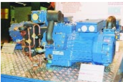
Im Vordergrund der Bock-Messepräsentation stand der neue zweistufige Typ HGZ 7, dessen einstufige Variante als erste das Verdichterüberwachungsmanagement BCM 2000 beinhaltet
