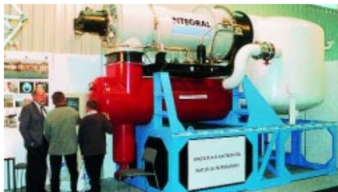
Die Klimakältemaschine mit Wasser als Kältemittel dominierte den Messestand der Integral Energietechnik GmbH
