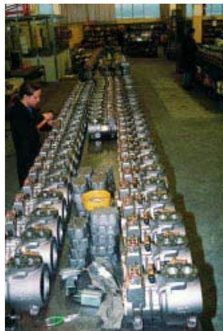
*Massenproduktion von semihermetischen Verdichtern bei Frascold, noch immer ohne Montageband*
