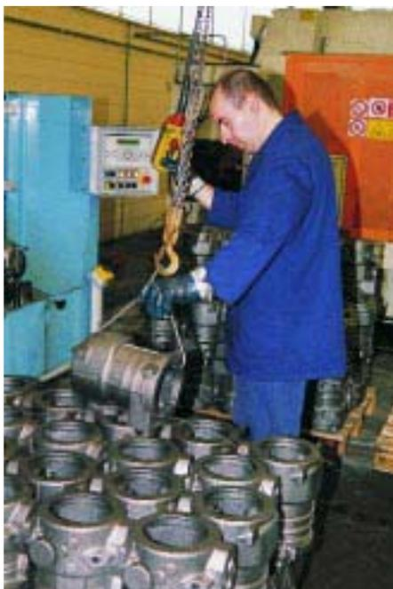
*Vorbereitung der maschinellen Gehäusebearbeitung durch Festlegung und Bearbeitung der Fixierpunkte am Gehäuserohling*
