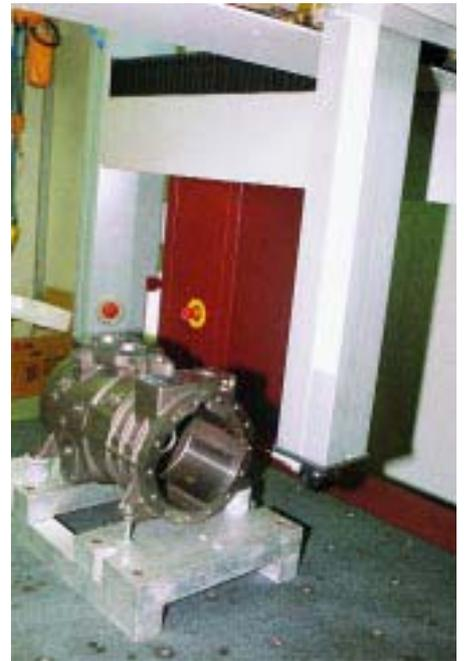
Qualitätssicherung durch berührungslose Vermessung aller Dimensionen eines Gehäuses in drei Achsen
