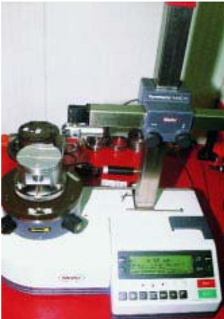
Meßtechnische Überprüfung der Kolbenboden-Ausfräsung auf Paßgenauigkeit, zum Gegenstück Saugventilzunge
