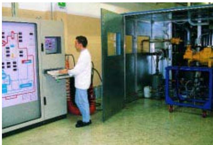
Endkontrolle für Schraubenverdichter auf dem Prüfstand
